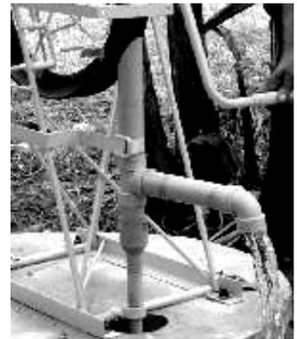
Différence de taille entre tube montant et tube supérieur
