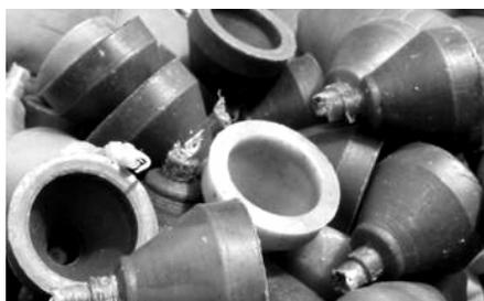
En général, à chaque mètre de la corde un piston doit être attaché (pour les installations très profondes, un piston à chaque 1 ½ m ou même 2 m peut être suffisant). Deux nœuds simples (un avant et un après le piston) est le moyen le plus simple pour fixer les pistons.
