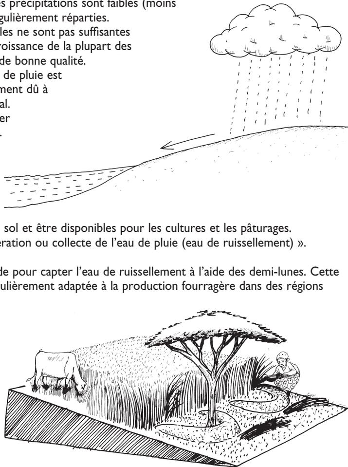
ils sont construits le long d'une même courbe de niveau. Les demi-lunes captent l'eau qui ruisselle en aval de la pente et lui permettent de s'infiltrer dans le sol. L'excédent d'eau qui s'échappe par les extrémités des ouvrages supérieurs de captage est récupéré plus loin dans les demi-lunes inférieures, en bas de la pente.
