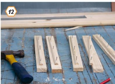
**12** Fixez 28 demi-ronds de 400 mm sur les 28 lattes de 500 mm – une agrafeuse est plus rapide...
