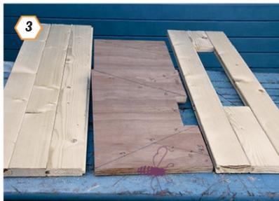
**3** Percez sur les pignons, avec un foret à bois de 4 mm, les points 9, 19 et 28. Les points 5 et 10 seront percés avec un foret à bois de 8 mm. 3 lames de 100 mm forment la façade arrière, 2 lames séparées par des éléments de 20 cm (à l'avant) et 30 cm (à l'arrière) permettront d'installer la vitre.
